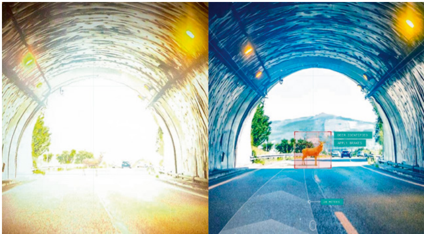
BILD 2 Eine leistungsfähige Bilddatenverarbeitung erhöht die Erkennungsleistung auch unter ungünstigen Umgebungsbedingungen (© Ambarella)
